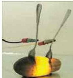
در خیار شور یون های مثبت (سدیم) و منفی (کلر) وجود دارد. هرگاه جریان برق با ولتاژ بالا ( $110$  ولت) را از درون خیار شور عبور دهیم. یون های سدیم با جذب انرژی جریان برق، از خود پرتوهای الکترومغناطیس گسیل می دارد که برای فلز سدیم نگ آن زرد است.
